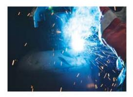
درمرحله بعدی سیلندر به دسته و پایه جدید مجهز میگردد , جوشکاری دسته و پایه توسط دستگاه نگهدارنده سیلندر انجام می گیرد. توضیح اینکه : درهنگام تولیددسته ,عملیات حک مشتخصات شرکت مالک و مشخصات فنی سیلندر بهمراه علامت استاندارد انجام می گردد.
