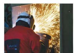
دراین قسمت توسط ماشین آلات ویژه و سیستم جدید پلاسما ، کارجداسازی دسته وپایه به طور دقیق انجام میشود. این مرحله به لحاظ وجود جوشهای کهنه درمحل اتصال دسته و پایه دقت بیشتری را می طلبد که به بدنه سیلندر آسیبی نرساند.
